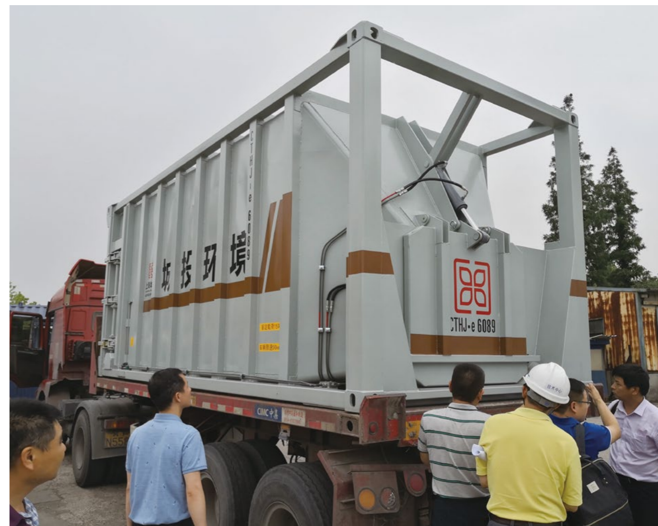
对餐厨垃圾专用集装箱进行运输稳定性验证
