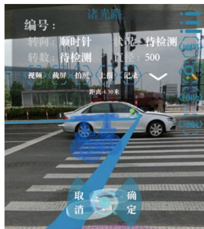
上海城投水务供水管理所利用 AR 新技术对国家会展中心核心区域进行阀门巡检
