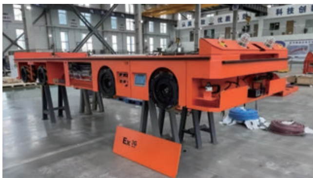
电气液压与某航天企业联合研发的重载 AGV 智能搬运车液压动力系统
